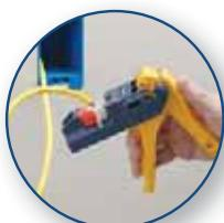
4. Удостоверьтесь что разъем полностью и надежно установлен в зажим, IDC-контактами в сторону лезвий.
