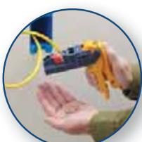
6. Провода будут установлены и обрезаны для обеспечения надежной заделки.
