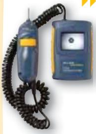
FiberInspector Mini позволяют производить осмотр как оптических портов так и разъёмных соединителей. Несмотря на свою портативность позволяет быстро и четко выявлять дефекты и загрязнения.
