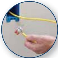
2. Определите схему разводки. Снимите изоляцию со всех проводников.
