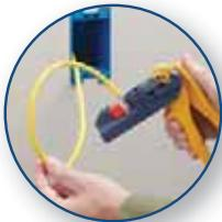
3. Вставьте модуль в JackRapid передним концом вперед, направляя IDC-контакты в сторону лезвий инструмента.
