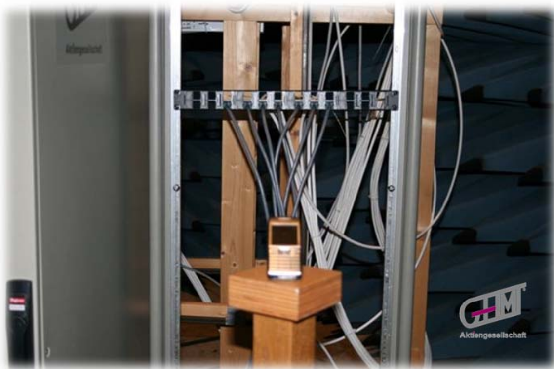
Рис.6 Испытания воздействия беспроводных устройств на кабельную проводку
