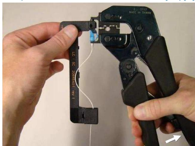
29. Взять клещи двумя руками и сжать ручки до конца. Во время раскрытия клещей левой рукой придерживать держатель с соединителем, правой – ручки клещей, чтобы избежать рывков.
