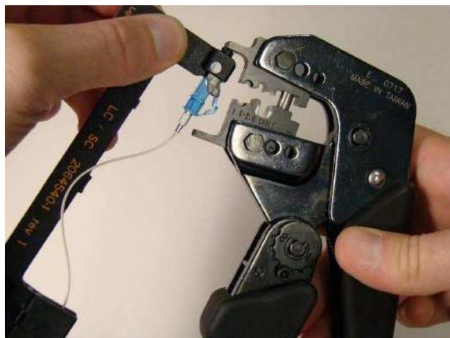
27. Осторожно вставить концевик соединителя в зубец обжимной матрицы.
