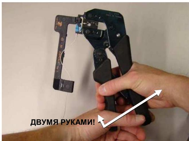
30. После обжима можно увидеть контрольную отметку, т.к. концевик стал короче: его подвижная часть (плунжер) частично зашла внутрь.
