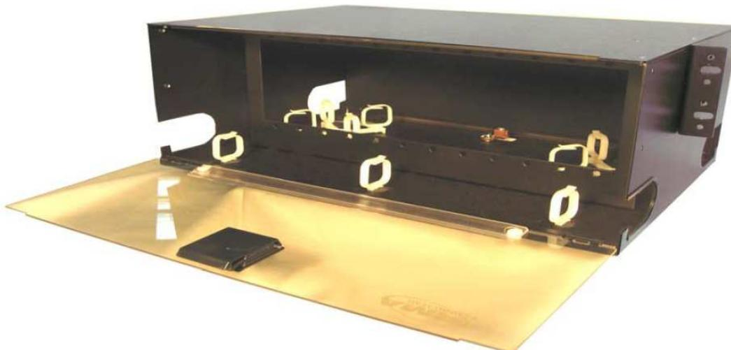
Интегрированный передний кабельный организатор позволяет обеспечить подключение и укладку до 144 дуплексных коммутационных шнуров с соблюдением допустимых радиусов изгиба. Прозрачная пластиковая крышка защищает коммутационные шнуры от случайных повреждений.
