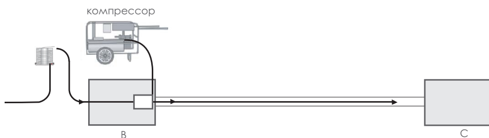
Рис. 42. Установка микрокабеля длиной свыше 1000 м. Процесс пневматической прокладки на участке В – С
