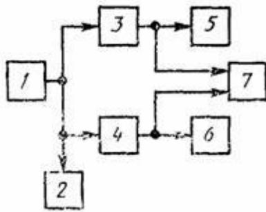
1 - низкочастотный генератор сигналов; 2 - вольтметр; 3 - канал А; 4 - канал В; 5, 6 - номинальное сопротивление нагрузки - резистор; 7 - фазометр
