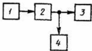
1 - резистор - эквивалент сопротивления источника; 2 - измеряемый тракт или звено; 3 - номинальное сопротивление нагрузки - резистор; 4 - псофометр
