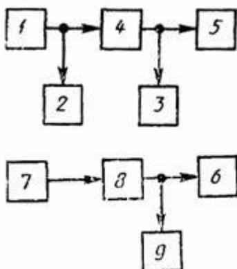
1 - низкочастотный генератор сигналов; 2, 3 - вольтметры; 4 - тракт, вносящий помеху; 5, 6 - номинальное сопротивление нагрузки - резистор; 7 - резистор - эквивалент сопротивления источника; 8 - испытуемый тракт; 9 - анализатор спектра или селективный вольтметр
