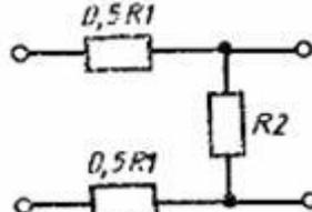
Резисторы должны быть неволочными с допуском не более  $\pm 1\%$ , и при необходимости экранированы. Сопротивление резистора  $R2$  должно быть не более 0,01 от  $R_{вх}$  тракта формирования программ. Сопротивление  $R1$  должно равняться  $R2$ .
