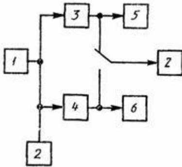
1 - низкочастотный генератор сигналов; 2 - вольтметр; 3 - канал А; 4 - канал В; 5, 6 - номинальное сопротивление нагрузки - резистор
