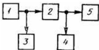
1 - низкочастотный генератор сигналов; 2 - измеряемый тракт или звено; 3 - вольтметр; 4 - измеритель нелинейных искажений или анализатор спектра; 5 - номинальное сопротивление нагрузки - резистор
