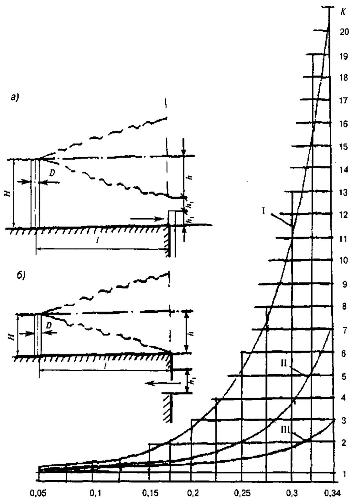
a - расположение источника над зоной всасывания наружного воздуха приемным устройством (высота трубы источника  $H = 2h_1 + h$ ); б-то же, над кровлей здания (высота трубы источника  $H = h$ );
