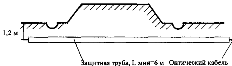
Рисунок В.1 - Прокладка ОК через автомобильную дорогу
