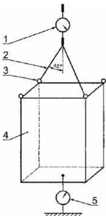
1 - динамометр 1; 2 - строп; 3 - строповое устройство; 4 - ВРУ; 5 - динамометр 2
