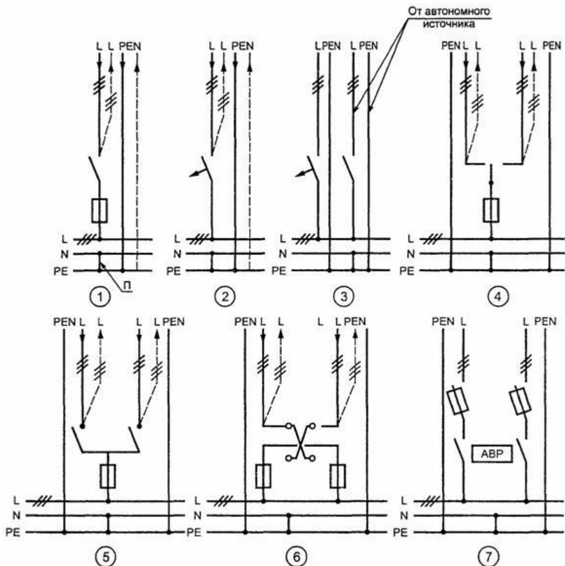
L - фазные проводники; N - нулевой рабочий проводник; PE - нулевой защитный проводник; PEN - совмещенный нулевой рабочий и защитный проводник; П - перемычка по 6.3.15
