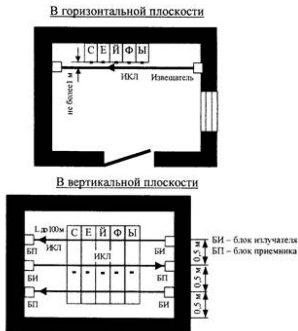
Вариант 5. Блокировка сейфов (предметов) извещателями активными оптико-электронными
