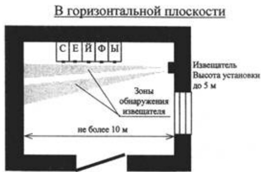
Вариант 4. Блокировка сейфов (предметов) извещателями поверхностными оптико-электронными с зоной обнаружения типа "занавес"
