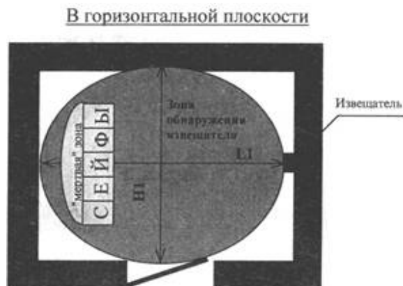
Вариант 5. Блокировка сейфов (предметов) извещателями активными оптико-электронными
